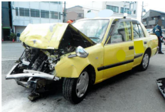
写真 1 当該車両の損傷状況（左前部）
