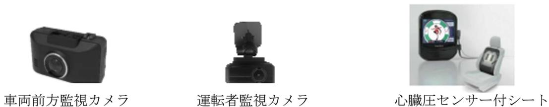
図7 運行中における運転者の疲労状態等を測定する装置のイメージ
