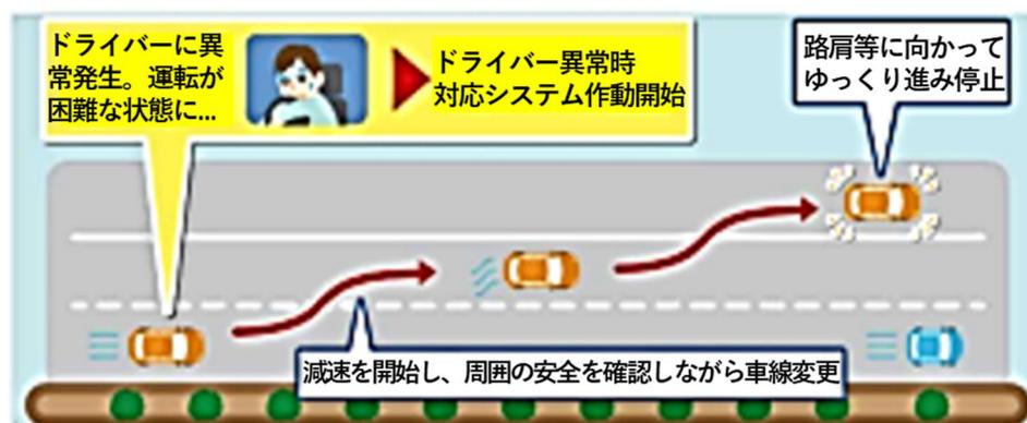
図9 ドライバー異常時対応システム<sup>3</sup>のイメージ
